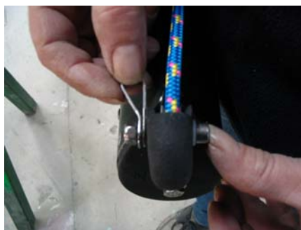
Montage du pontet à œil
