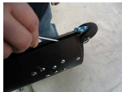
Passage de la nouvelle drisse
