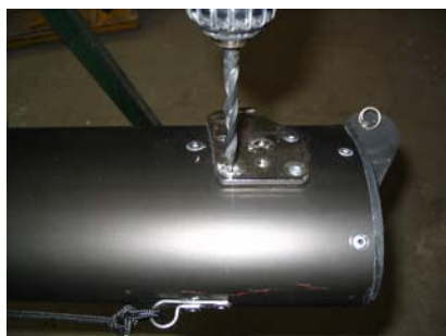
Démontage de la platine du Hook
